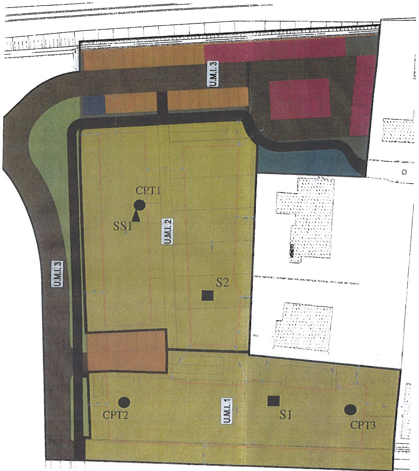
Fig. 10 – Planimetria ambiti di intervento, ● prova penetrometrica statica (CPT); ■ sondaggio(S); ▲ Sismica passiva a stazione singola. Scala 1:600.
